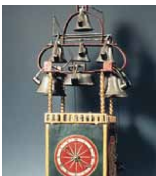
Horloge en fer à carillon, France, début du 17 e siècle. Une des cloches porte la signature: Jean Dubois au Puy. Le carillon comporte neuf cloches dont huit servent au jeu de la mélodie et une à la sonnerie des heures. Il est déclenché à chaque quart d'heure par le mouvement de l'horloge.
