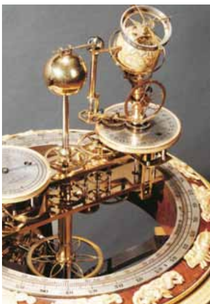
Pendule à planétaire signée Raingo (planétaire, musique et décor) et Antide Janvier (mouvement de la pendule) à Paris. Premier quart du XIX e s. [détail du planétaire]
